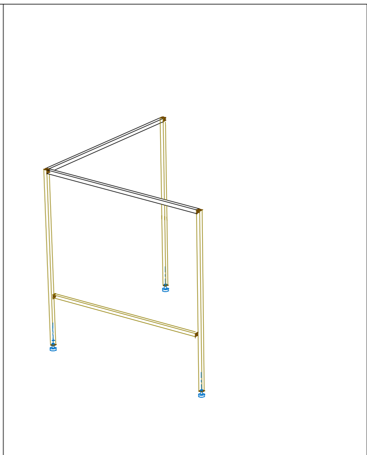
3 2で組んだフレームをL型につなげます。
